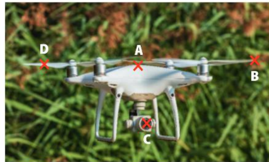
FIGURE 2 – A : point au sommet du drone - B : point à l'extrémité d'une hélice - C : point de la caméra - D : point au milieu d'une hélice.
