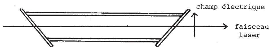
Fig. 18. — Tube pour laser à gaz avec fenêtres à incidence de Brewster.
