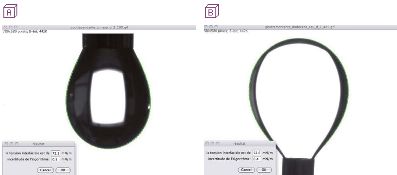
Figure 4 - Capture d'écran du logiciel DROPFIT , on peut voir en vert le profil théorique qui s'ajuste le mieux à l'image de la goutte. [A] goutte pendante d'eau dans l'air - [B] goutte montante de dodécane dans l'eau.
