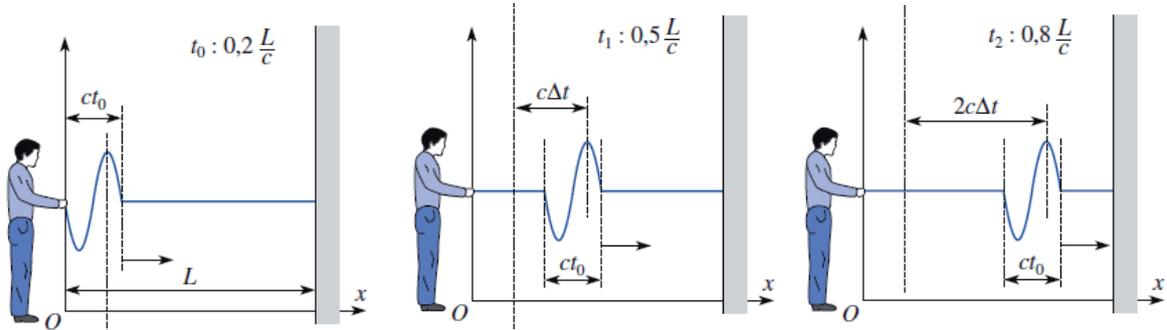
FIGURE 1 – Propagation d’une déformation imprimée à la corde  $c\Delta t = 0.3L$ , clichés à  $t_0$ , puis  $t_0 + \Delta t$ , puis  $t_0 + 2\Delta t$ ...
