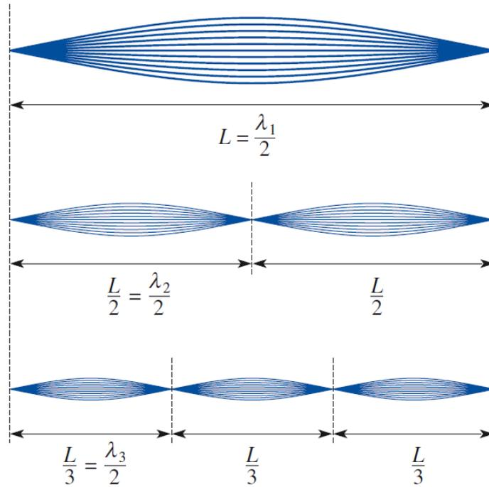
FIGURE 2 – La corde de Melde en résonance ( $n = 1, n = 2, n = 3$ )
