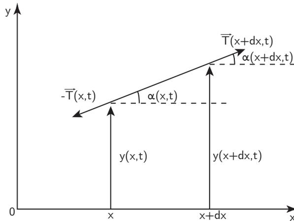
Soit une corde sans raideur, inextensible, de masse linéique constante  $\mu$ , est tendue par une tension  $\vec{T}$ . Au repos elle se confond avec l’axe  $Ox$ .
